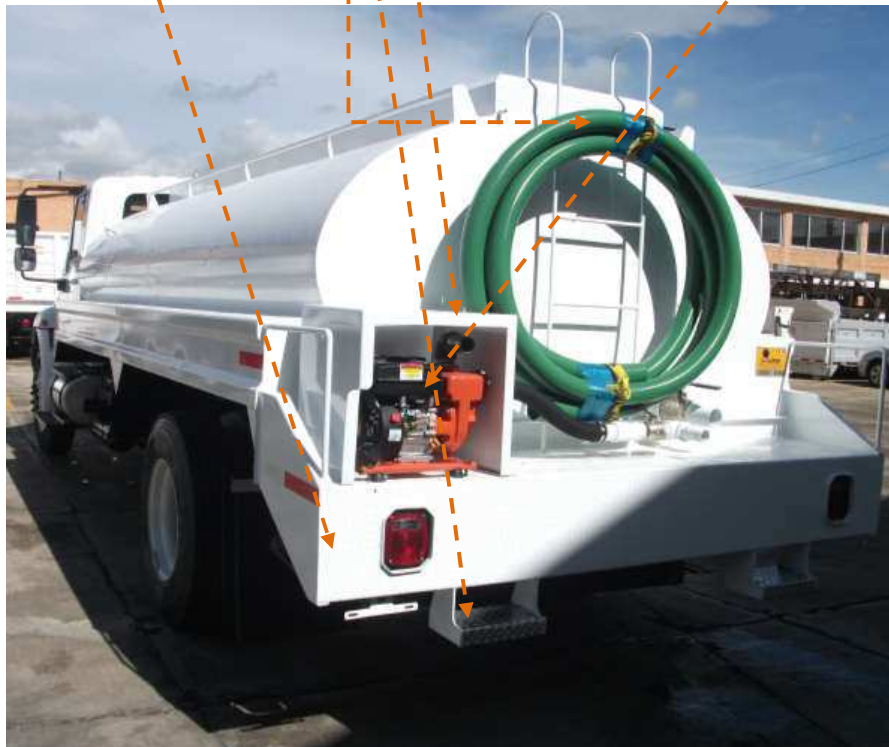
IMAGEN 5. FALDON TRASERO, BASE PARA BOMBA, EQUIPADO CON MOTOBOMBA. 10 MT. DE MAGUERA, ESCALON TRASERO,
